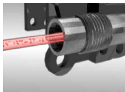
Abb. 1 Ein verunreinigtes Fluid wird in die Laserkammer mit der optischen Abtastfunktion geleitet, in der ein gleichmäßiger Durchfluss und eine ausgewogene Fluidverteilung sichergestellt werden sollen.
