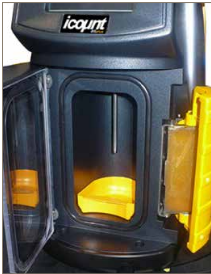
Abb. 4 Die Ölprobe wird mittels Probeentnahmerohr, welches automatisch in die Probeflasche ausfährt, entnommen.
