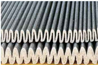
Die obige Abbildung zeigt einen „trockenen“ Par-Gel-Filter und dasselbe Medium angeschwollen durch aufgenommenes Wasser.
